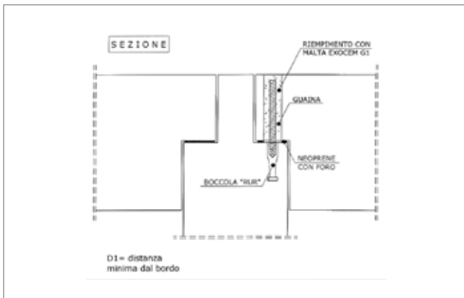
Unione trave-pilastra a cerniera
