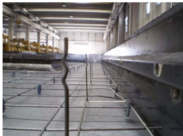
Fig. 12 Posizionamento della connessione Zigrinata sul bordo del pannello.
